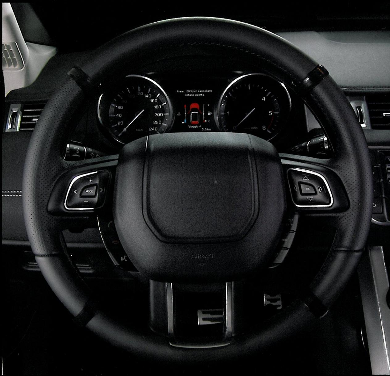
*Ghost* . . . un'innovativo e rivoluzionario sistema di accelerazione applicato direttamente nella parte posteriore del volante. Realizzato facendo tesoro dell'esperienza maturata, questo dispositivo con movimento rotativo (orario e antiorario), permette di accelerare mantenendo entrambe le mani sul volante e favorendo così le diverse condizioni di guida.
